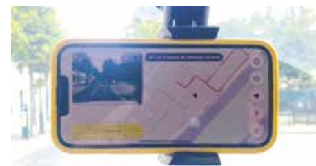
Dispositif d'analyse instantané de la voirie par caméra mobile
