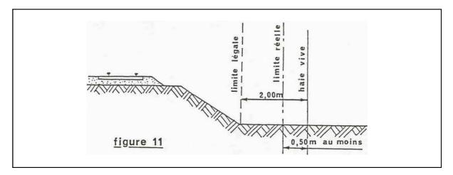
Dans tous les cas, l'application des règles ci-dessus ne doit pas conduire à planter un arbre à moins de 2 m de la limite réelle du chemin de fer et une haie vive à moins de 0,50 m de cette limite.
