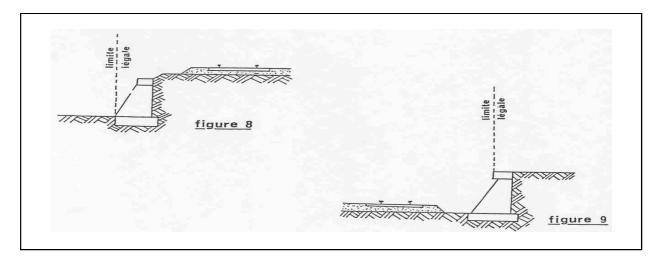
Lorsque le chemin de fer est établi en remblai et que le talus a été rechargé ou modifié par suite d'apport de terre ou d'épuration de ballast, la limite légale pourra être déterminée à partir du pied du talus primitif, à moins toutefois, que cet élargissement de plate-forme ne soit destiné à l'établissement prochain de nouvelles voies.
