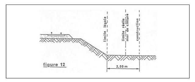
Il en résulte des dispositions précédentes que si les clôtures sont autorisées à la limite réelle du chemin de fer, les constructions doivent être établies en retrait de cette limite réelle dans le cas où celle-ci est située à moins de 2 m de la limite légale.
