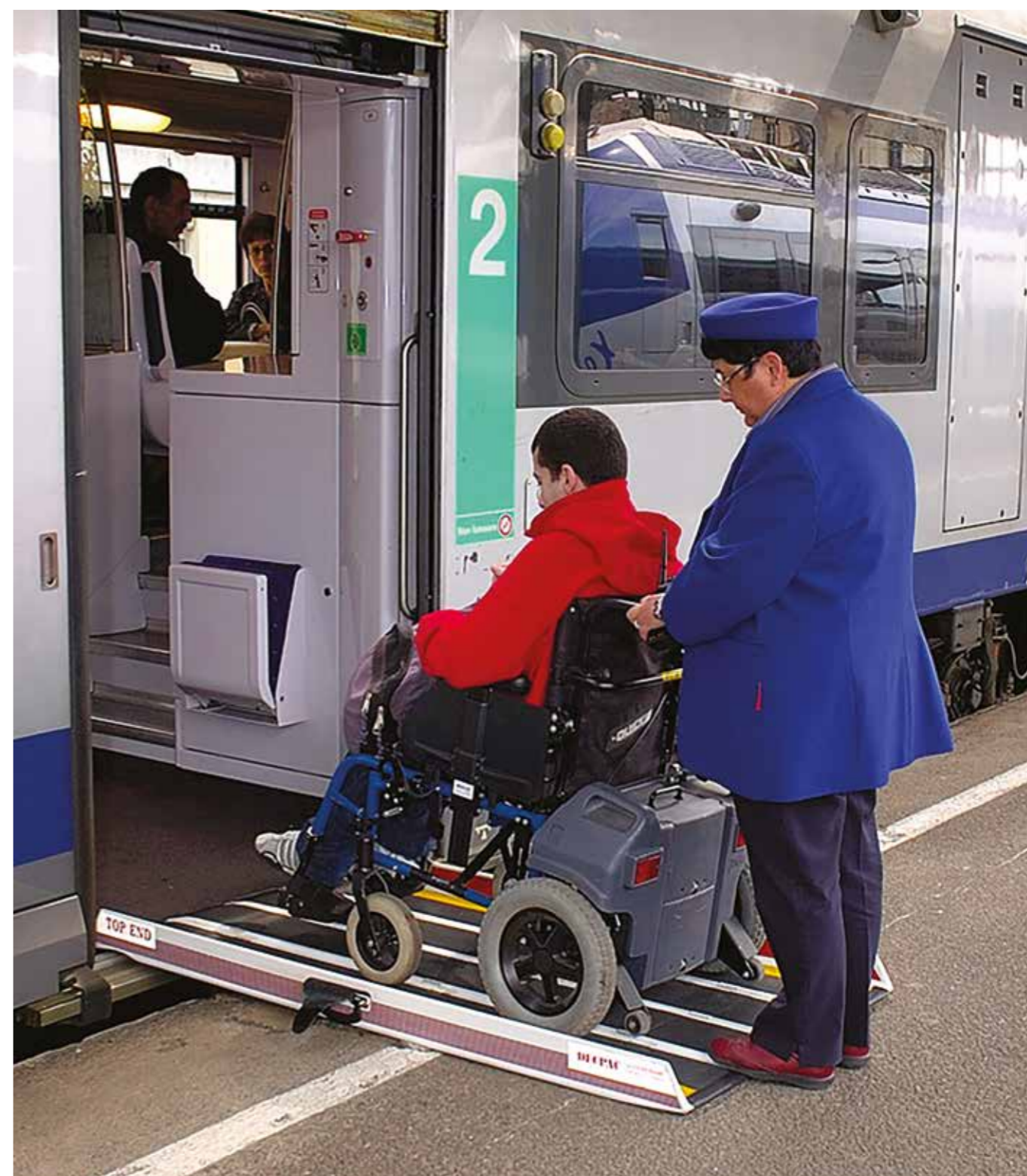
Rampe pour personne à mobilité réduite permettant l'accès au train
