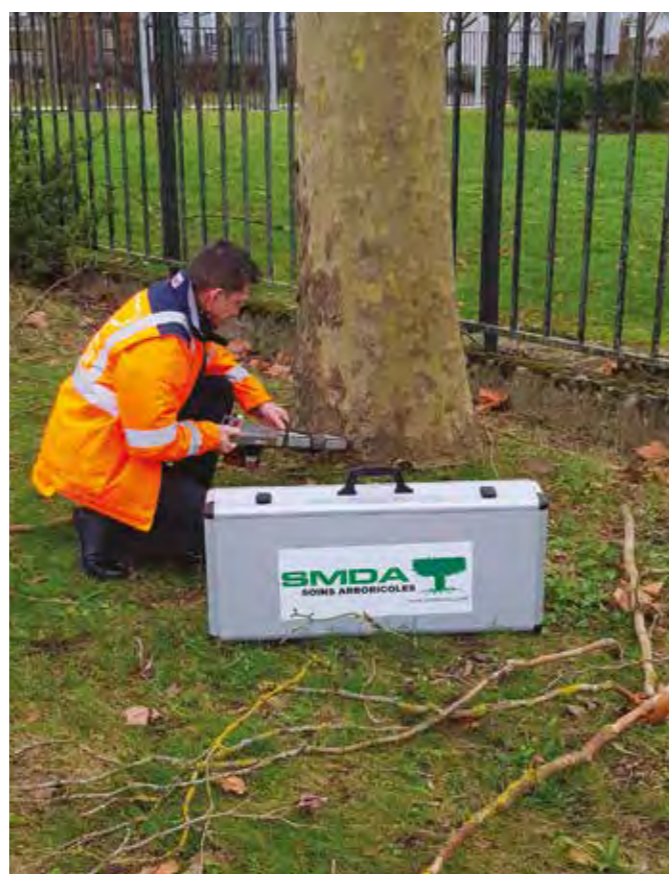
Sondage au pénétromètre pour évaluer la santé d'un Platane
